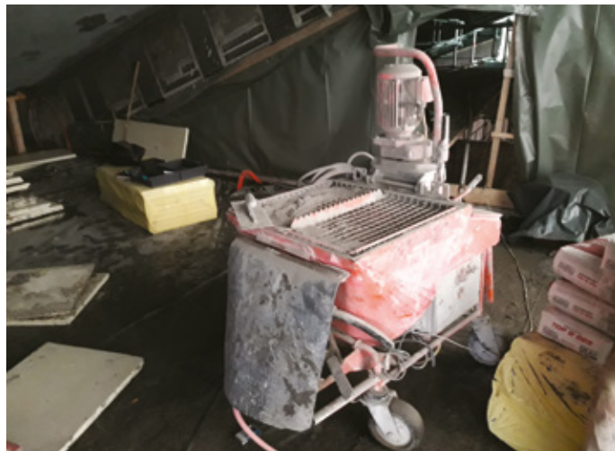
Slika 1: Oprema za strojni nanos Geoactive Top B 525 - reparaturne malte razreda R4
