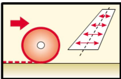
4. Geotekstil in geomreža se razrola, pri čemer se pri smeri upošteva načrt vgradnje in/ali navodili geomehanika. Navadno pri geotekstilih za ločilni sloj (Polyfelt TS) smer ni pomembna. Zelo pomembna je pri armaturnih geosintetikih (Geolon PP, Geolon PET, Miragrid GX), še posebej, če je moč v obeh smereh različna.
