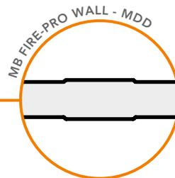
I pannelli metallici bilamiera con isolamento in lana di roccia minerale a fibre orientate Marcegaglia Buildtech sono adatti alla realizzazione di pareti interne ed esterne di edifici civili e industriali che necessitano di particolari prestazioni di reazione e resistenza al fuoco.
