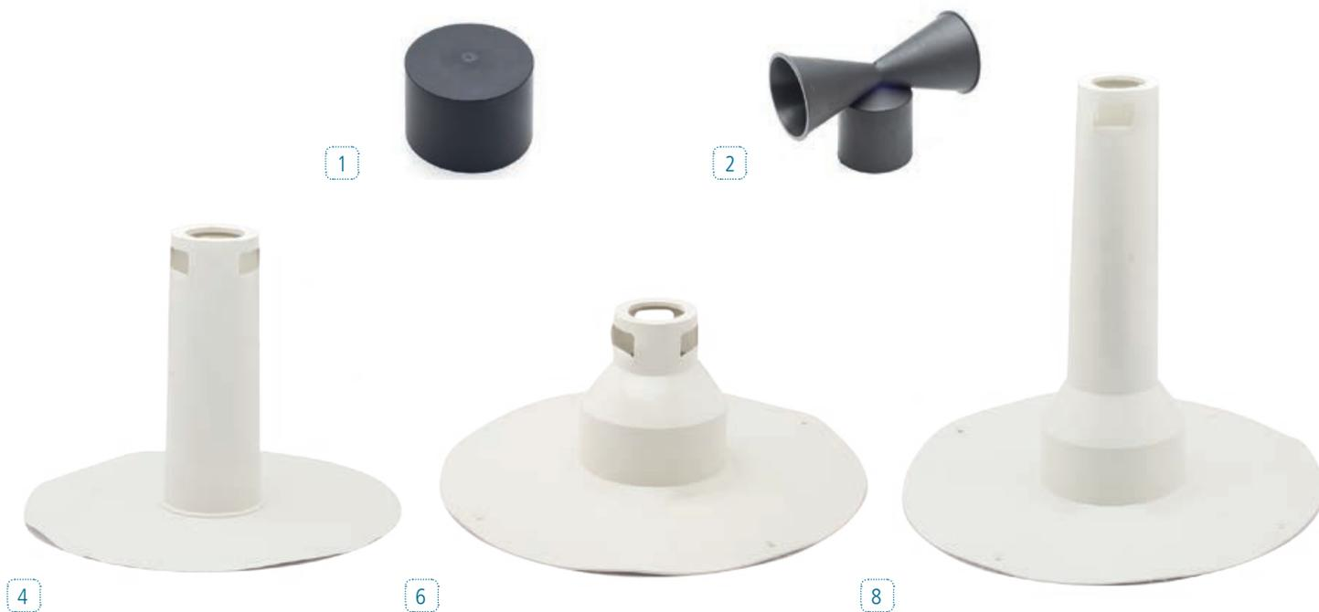
Gli **AERATORI IDEAL IN PVC** sono progettati per favorire l'estrazione dinamica del vapore acqueo che si forma tra la soletta e il manto impermeabile di copertura. Per ottenere il massimo risultato si consiglia la posa di 3-4 aeratori ogni 100 mq. Possono essere utilizzati anche come caminetti d'aerazione per ambienti, soprattutto se abbinati al coperchio Estraeer.
