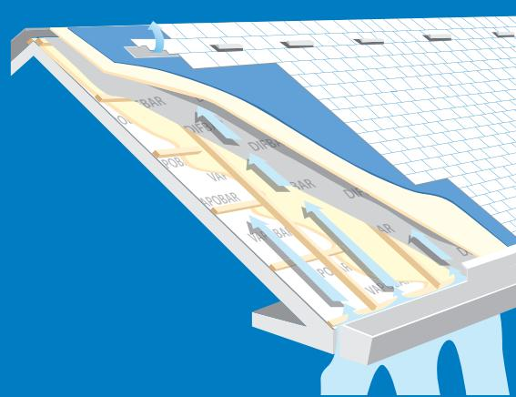
Varovanje kritičnih delov strehe s samolepilnim bitumenskim trakom
