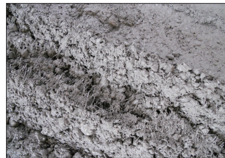
Svež beton s dodatkom makro vlaken Strux 90/40
