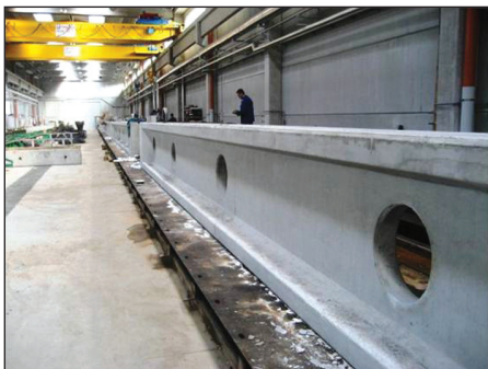
Dodatki za prefabricirane elemente poleg ostalih prednosti omogočajo tudi hitrejše razopaževanje.
