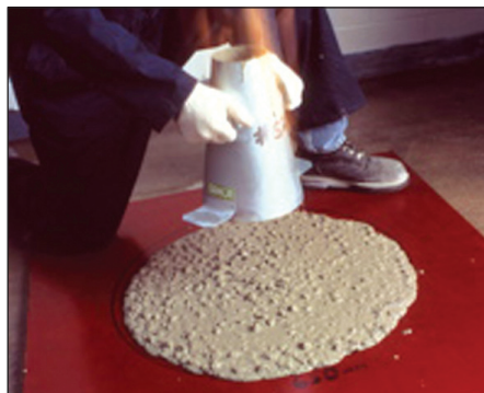
Testiranje svežega samozgoščevalnega (SCC) betona
