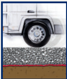
Stabilna cesta z uporabo TS
