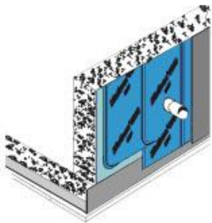
Kombinacija horizontalne hidroizolacije Preprufe 300R in vertikalne hidroizolacije Bituthene
