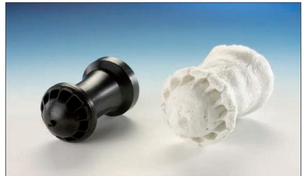
Die Faserfilzstruktur erhöht den Widerstand gegenüber Rissbildung und verhindert die Ausbreitung von Rissen deutlich stärker als kurzglasfaserverstärkte Werkstoffe. Beim Durchstossversuch wird die Prüfplatte nicht durchschlagen, sondern weist einen Bereich mit Scharnierbrüchen auf.
