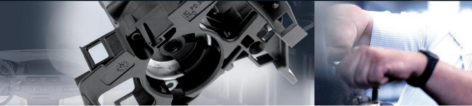
Verzug tritt bei allen verstärkten Kunststoffen auf. Unterschiedliche Schwindungen in und quer zur Faserorientierung führen je nach Bauteil zu Verformungen. Mit der optimierten Glasfaserverstärkung zeigen die Grivory GVX Typen eine signifikant reduzierte Verzugsneigung. Die Schwindung quer zur Faserorientierung im Vergleich zu anderen hochverstärkten Werkstoffen konnte um 25% reduziert werden. Dies führt zu wesentlich weniger verzogenen Bauteilen.
