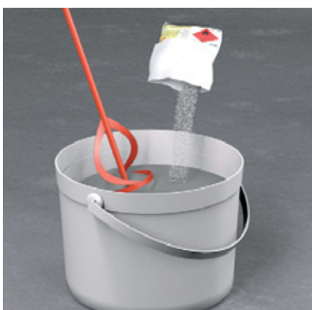
Dodamo katalizator (glede na mešalno tabelo, temperaturo in čas nanosa) in mešamo 2 minuti s počasnim mešalnikom. Pri temperaturah nižjih od 15 °C se čas mešanja podaljša na 4 minute. Majhne količine se lahko zmeša tudi ročno.
