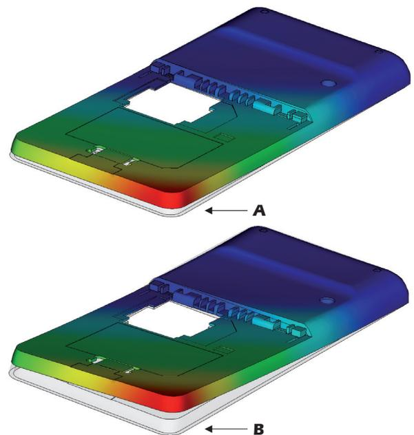
Die Moldflow-Analyse zeigt deutlich den unterschiedlichen Verzug von Grivory GVX (A) und herkömmlichen Produkten mit gleicher Glasfaser Menge (B). Der geringere Verzug ist nicht nur Moldflow-Theorie. Sowohl Prüfkörper als auch alltägliche Anwendungen bestätigen den geringen Verzug auf eindruckliche Weise.
