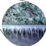
Mikroskopska povečava vezi med Preprufe membrano in betonom.
